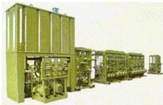
Приводная станция для заградительной плотины в городе Штере, защищающей от штормового прилива.
